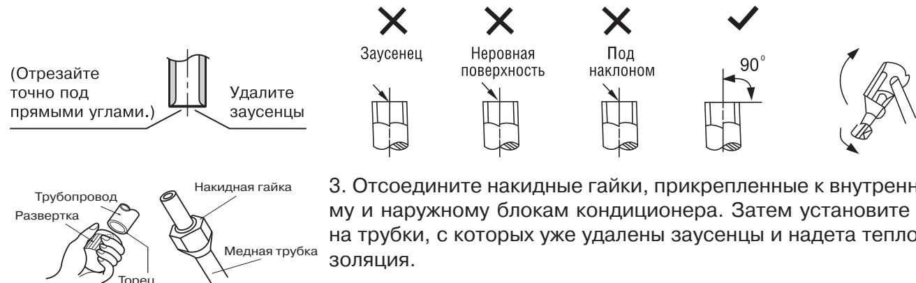
3. Отсоедините накидные гайки, прикрепленные к внутреннему и наружному блокам кондиционера. Затем установите их на трубы, с которых уже удалены заусенцы и надета теплоизоляция.
