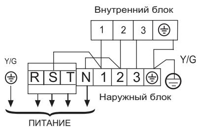
**HPU-42CH03, HPU-42HI03, HPU-42CF03:** 4 x 2,5 мм<sup>2</sup>, питание подается на наружный блок, для модели HPU-42CF03 дополнительно прокладывается провод подключения датчика защиты по низкому давлению.
