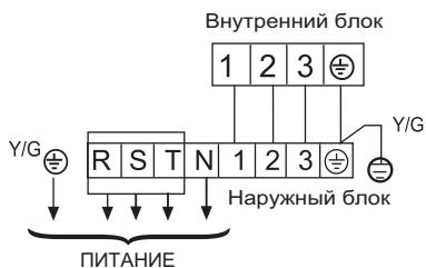
**HPU-42CV03, HPU-42HV03:** 4 x 2,5 мм<sup>2</sup>, питание подается на наружный блок.
