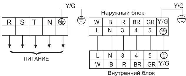
**HPU-42HF03:** 6 x 2,5 мм<sup>2</sup>, питание подается на наружный блок, дополнительно прокладывается провод подключения датчика защиты по низкому давлению и разморозки наружного блока.
