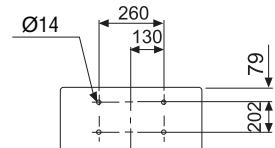
5. Для более надежной фиксации блока используйте уголки и фиксатор, входящие в комплект аксессуаров. Уголки необходимо прикрепить к боковым поверхностям нижней части корпуса блока и к поверхности пола. Фиксатор крепится к верхней части внутреннего блока и к поверхности стены.
