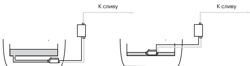
2. Наливные помпы. Эти помпы имеют достаточно большой накопительный резервуар, в который дренажная вода поступает самотеком. Помпа выполнена в виде одного блока, имеет достаточно большие габариты и устанавливается ниже дренажной ванны. Применяется с кондиционерами большой мощности или с группой кондиционеров.
