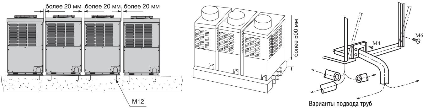
3. На высоте 2 м от блока не должно быть никаких помех движению воздуха. В противном случае необходимо установить адаптер, отклоняющий воздушный поток. При монтаже наружного блока оставьте достаточно места для технического обслуживания (не более 800 мм).
