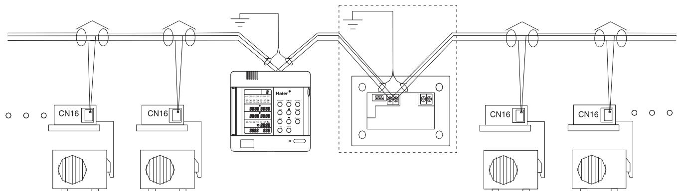
**Принципиальная схема подключения согласователя работы YCJ-A001 с двумя кондиционерами**
