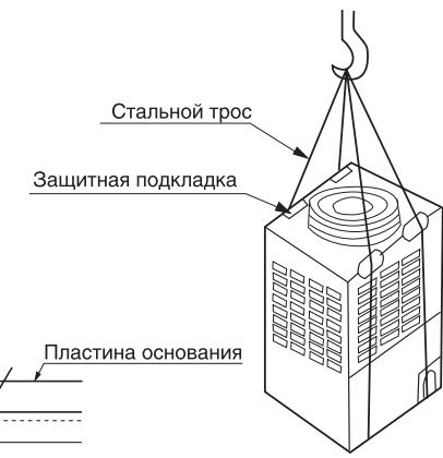
2. Основание для установки блока должно быть прочным во избежание излишних вибраций и шумов. Если агрегат устанавливается на крыше, проверьте, обладает ли она достаточной прочностью и хорошо ли стекает вода. При нижнем боковом подключении трубопровода и монтаже агрегата на выносной раме толщина данной рамы должна составлять более 500 мм.
